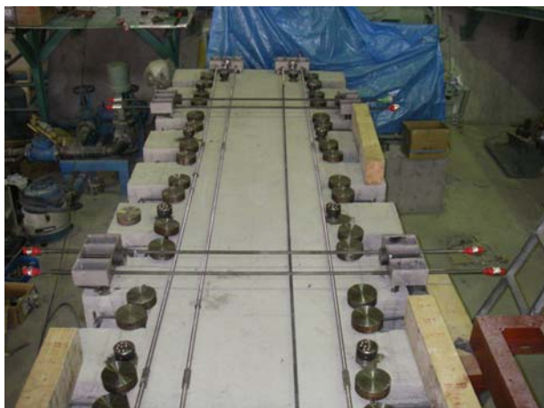
9.5 ton エンジン用にアンカー一体型ライナを配置
